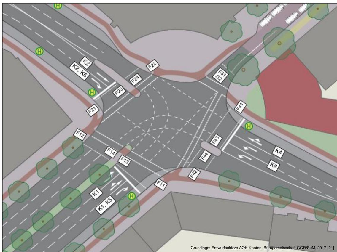
Abbildung 19: AOK-Knotenpunkt – Verkehrstechnischer Vorentwurf zum Knotenausbau [21]
